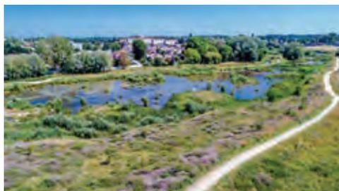
Le site s'étend sur 12 ha de zone d'expansion de crue réalisée sous forme de zones humides, avec un linéaire de rivière restaurée de près de 900 mètres.
